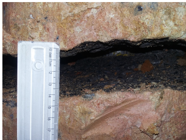
Figura 7. Verificação visual do seccionamento da estaca
