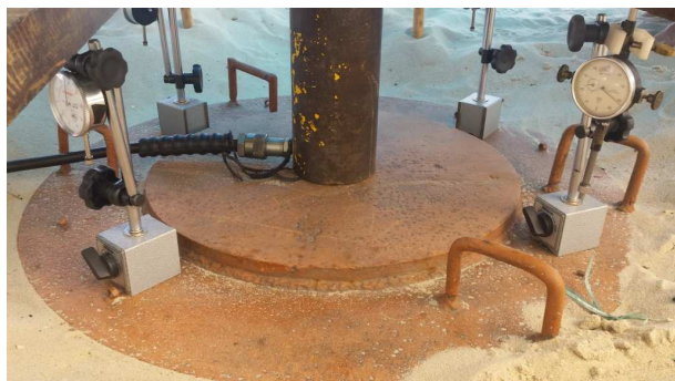
Figura 6. Instrumentação e sistema de aplicação de cargas para a placa de 80 cm (Gomes, 2016).
