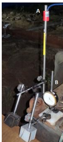
Figura 3. VWDT (A) e Relógio comparador analógico (B) – Segundo caso de obra.
