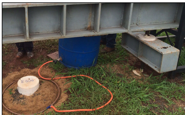
Figura 2. Sistema de umedecimento do solo, antes da cobertura com lona plástica.
