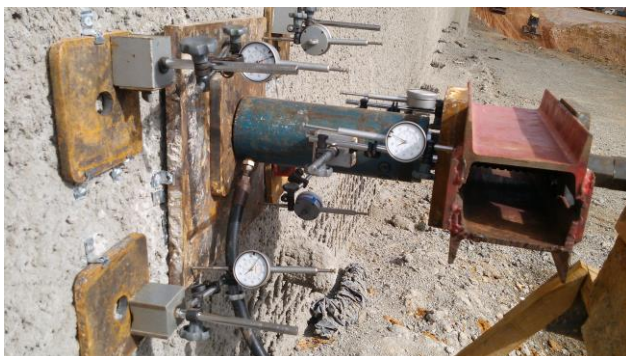
Figura 8. (a) vista geral do ensaio de arrancamento.
