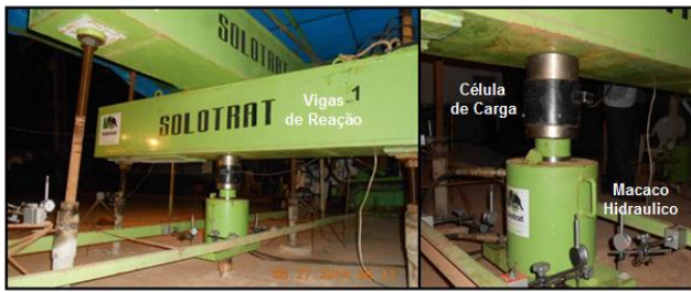
Figura 6. Montagem da prova de carga
