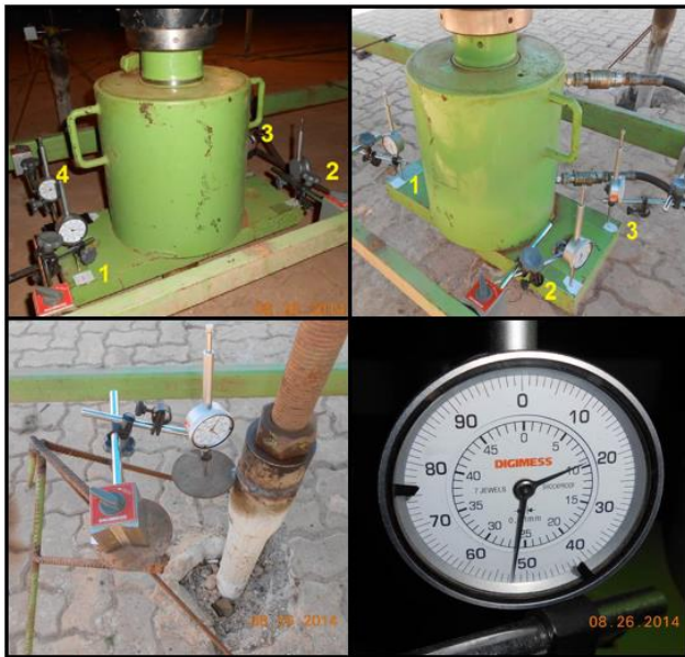
Figura 7. Extensômetros nas microestacas de reação e de teste
