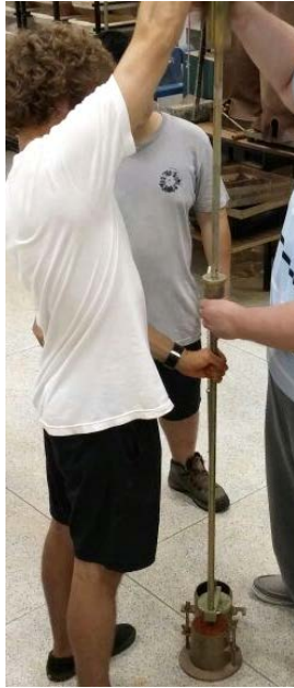
Figura 3. Ensaio DCP feito juntamente com o ensaio de compactação.
