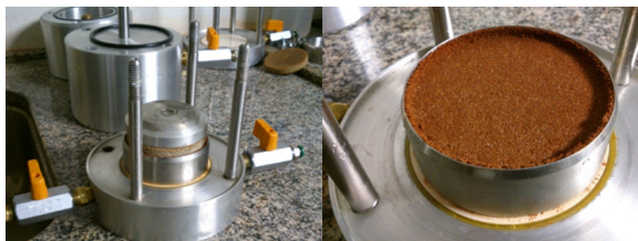
Figura 3. Câmara edométrica desmontada e corpo de prova após a realização do ensaio.
