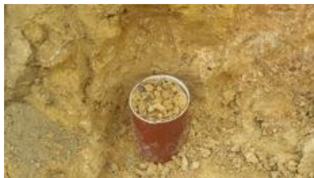
Figura 2. Coleta de amostra indeformada.
