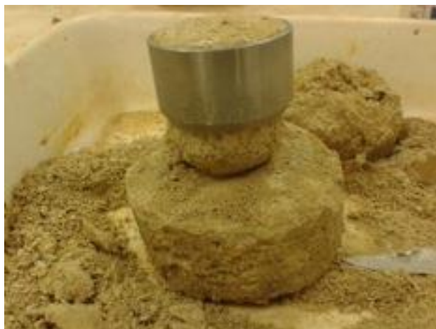
Figura 4. Amostra indeformada sendo talhada.
