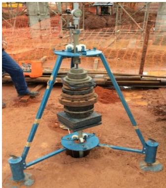
Figura 2 - Ensaio com Expansocolapsômetro em andamento.
