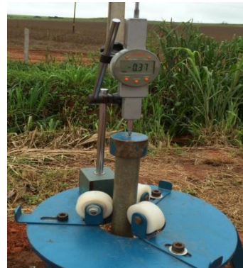
Figura 4 - Extensômetro, Placa e Roldanas do Expansocolapsômetro.
