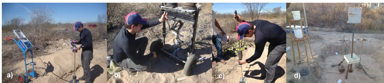
Figura 2. Investigação: a) LWD, b) Penetrômetro Estático, c) Penetrômetro de Impacto, d) Expansocolapsômetro (1ª versão).
