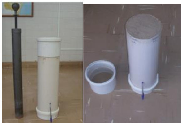
Figura 2. Compactação do solo no Lisímetro
