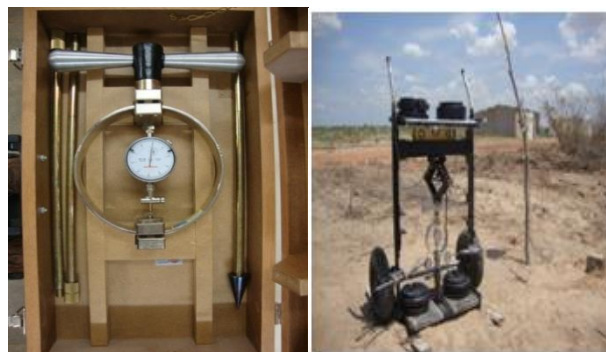
Figura 1. Ensaios em campo com Penetrômetro Estático
