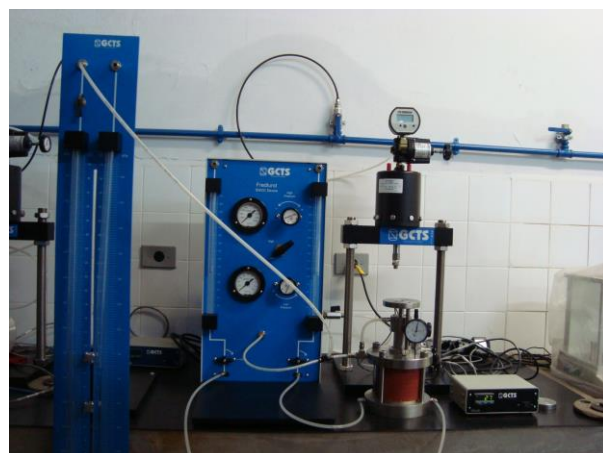
Figura 2. Prensa de adensamento com controle de sucção/pressão da marca GCTS, modelo Fredlund SWC-150 (BORGES, 2010).
