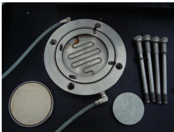
Figura 3. Detalhes da base da câmara de pressão, pedra porosa, parafusos e sobre peso (BORGES, 2010).
