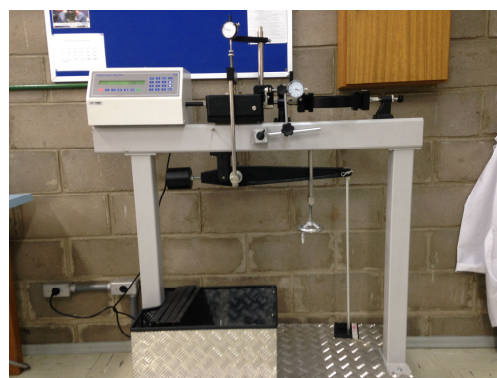
Figura 3. Equipamento de cisalhamento direto utilizado
