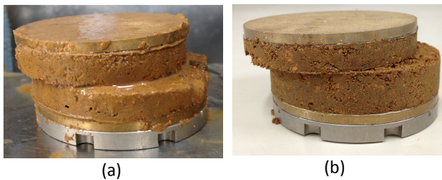
Figura 4. Corpos de prova após a execução dos ensaios de cisalhamento direto: (a) saturado e (b) não saturado para o “solo SEM”
