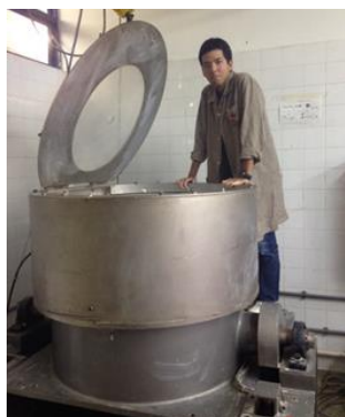
Figura 4: Centrífuga de tambor COPPE-UFRJ na sua posição de voo, horizontal.
