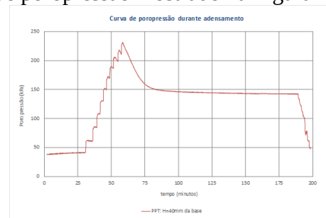
Figura 7: Curva típica de poropressão (kPa) versus tempo (min) com base em instrumentação instalada.
