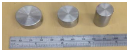
Figura 2: Placas de diferentes diâmetros utilizadas nos ensaios.
