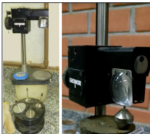
Figura 9 - Equipamento cone sueco (Geonor) e ensaio em execução (solo amolgado do ponto 1A, prof. 38,40m), (Barreto, 2015).
