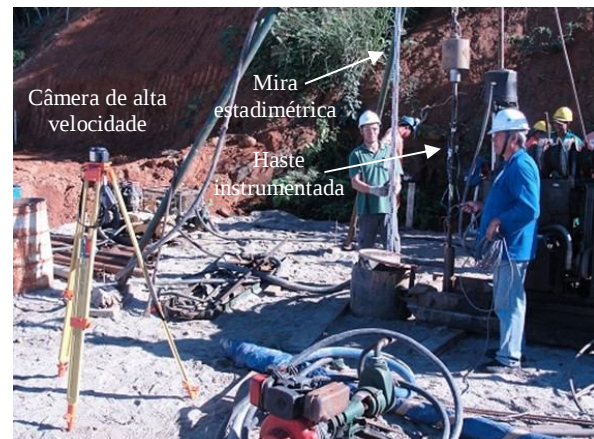
Figura 1. Esquema do monitoramento do SPT.
