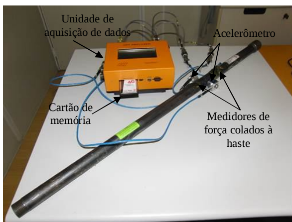
Figura 3. Sistema de medição de energia na composição de hastes.
