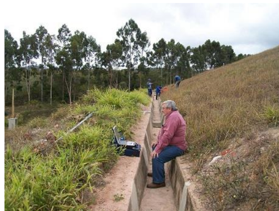
Figura 3. O CPU do GPR é posicionado e ligado às antenas, as quais se deslocam ao longo do perfil. Este perfil foi levantado na cota de 13 m na face jusante do corpo da barragem.
