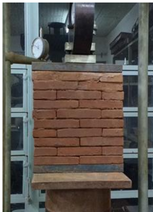
Figura 3. Acondicionamento de mini parede entre placas de aço.
