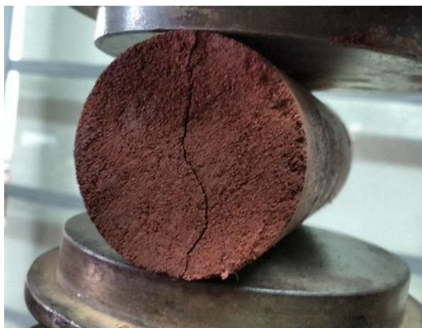
Figura 6. Corpo de prova após ruptura no ensaio de resistência à compressão diametral.
