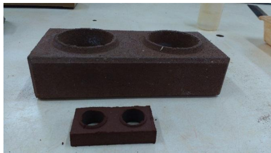
Figura 1. Comparação entre tijolo de solo cimento em escala real e escala reduzida 1:3.
