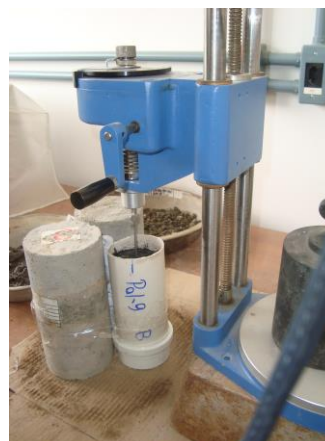
Figura 4. Ensaio de palheta de laboratório na subamostra Pal9.
