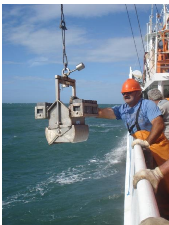
Figura 2. Amostrador de fundo tipo Ekman.
