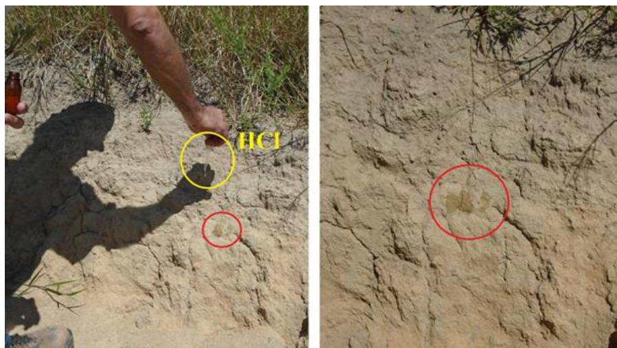
Figura 2 - Ácido clorídrico sendo gotejado no solo
