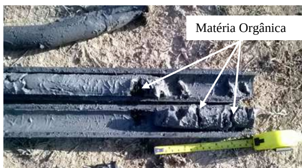
Figura 4. Sondagem SP-E1.34, Prof. 10,00 m, com presença de Matéria Orgânica (restos vegetais).
