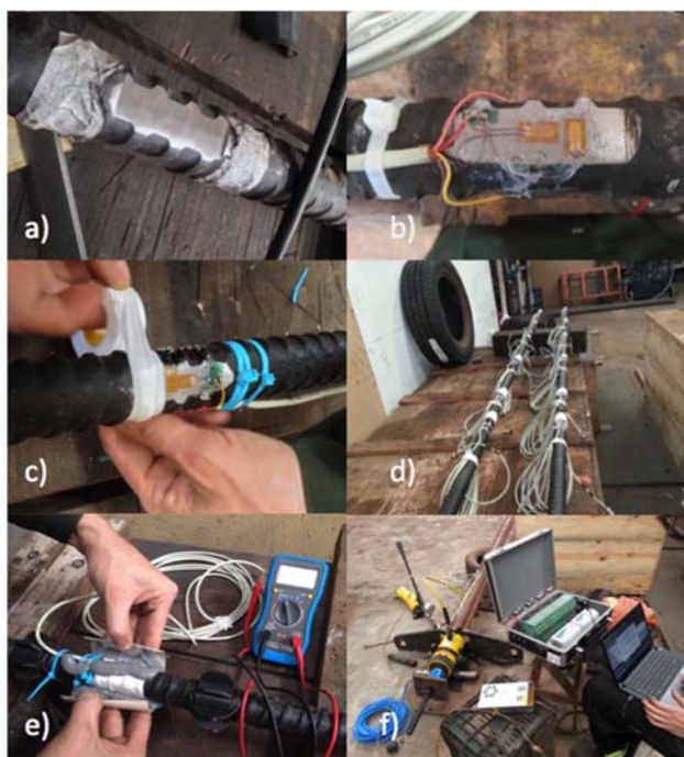
Figura 6. a) superfície lixada, b) Pontes de Wheatstone após soldagem com cabos de aquisição de dados, c) proteção primária, d) visão geral das barras, e) aplicação de cola termonplástica e tubo PVC para proteção, e, f) calibração das barras.
