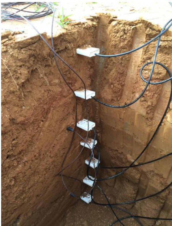
Figura 04 – Sensores instalados no perfil de cobertura.
