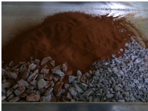
Figura 5. Mistura do solo e agregados
