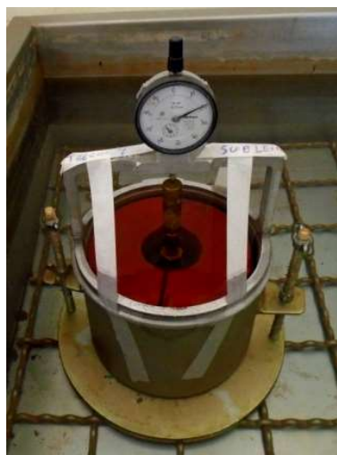
Figura 3. Compactação e imersão do cilindro de ISC.
