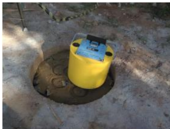
Figura 1. GeoGauge durante medições.
