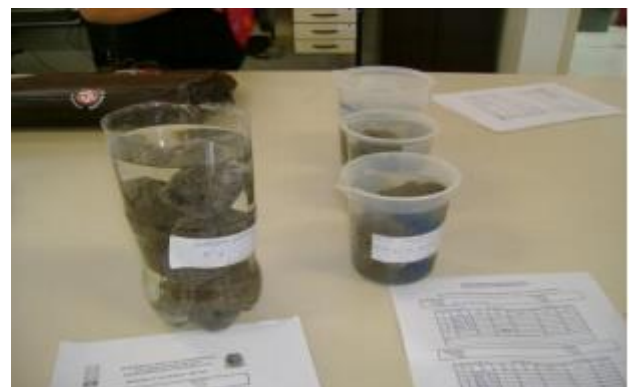
Figura 4. Ensaio de absorção da amostra de basalto.
