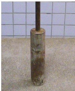
Figura 2. Soquete utilizado na compactação dos corpos de prova para os ensaios de permeabilidade.
