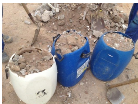
Figura 1. Amostras de RCD coletadas para determinação da composição gravimétrica.
