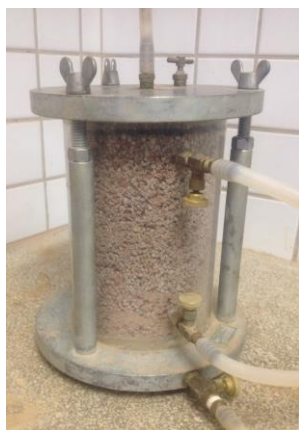
Figura 3. Permeâmetro contendo a amostra de RCD-R para o ensaio de permeabilidade à carga constante.
