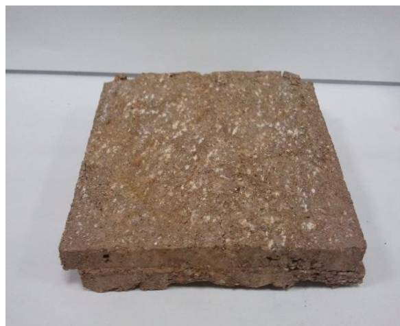
Figura 5. Orientação do bandamento micáceo perpendicular à superfície de ruptura.
