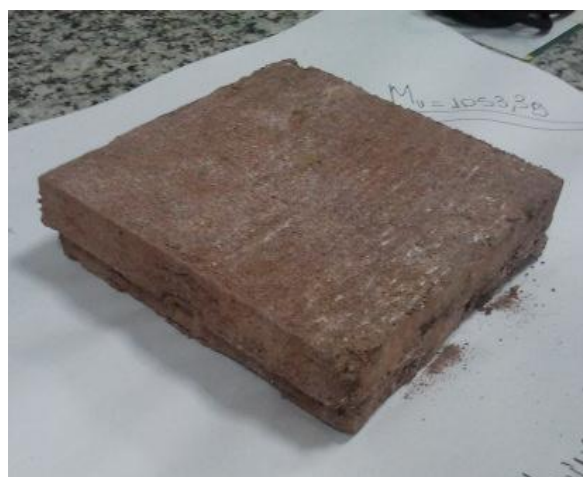
Figura 6. Orientação do bandamento micáceo paralelo à superfície de ruptura.
