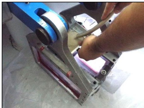
Figura 3. Colocação da areia no recipiente para a pluviação
