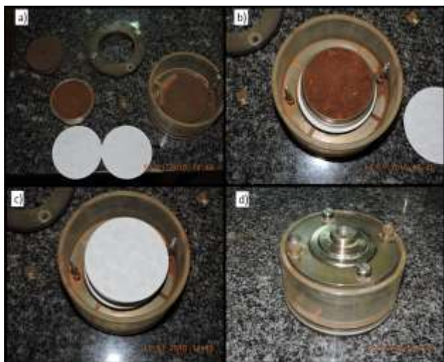
Figura 1. Etapas de montagem do ensaio de adensamento
