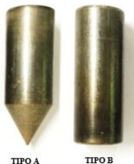
Figura 5 - Geometrias dos pilões: Tipo A (cônica) e Tipo B (cilíndrica)
