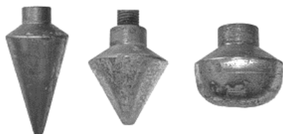
Figura 3 - Geometrias testadas: 1) 30°, 2) 60°, 3) hemisférico (Burlacu et al., 2013)
