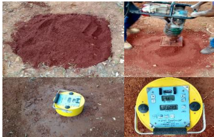
Figura 2. Processo de Compactação e Leituras com o equipamento.
