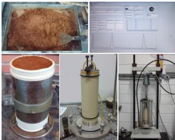
Figura 3. Passo a passo do processo de moldagem e montagem dos corpos de prova para a realização dos ensaios triaxiais de cargas repetidas.
