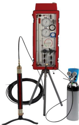
Figura 1. Foto do pressiômetro de Ménard, adaptado de Geomatech
