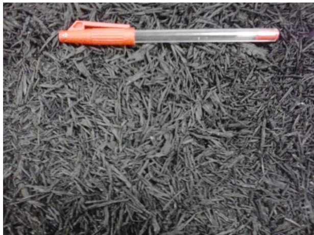
Figura 1. Amostra de resíduos de pneus coletada
