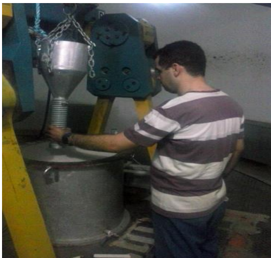
Figura 2. Pluviação do container.
