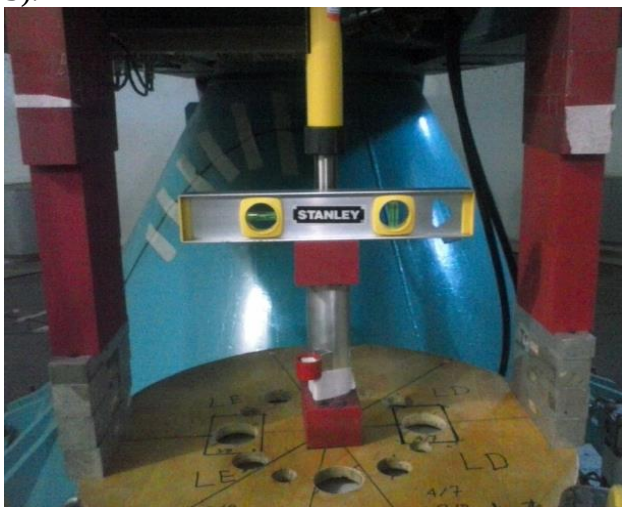
Figura 3. Cravação da estaca.
