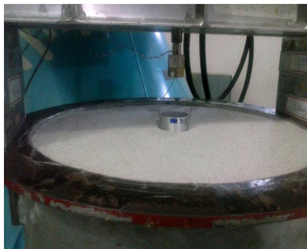
Figura 4. Estaca preparada para ser arrancada.
