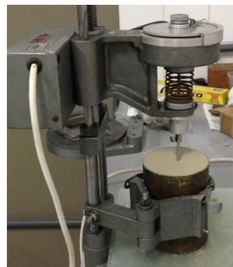
Figura 2. Equipamento utilizado para ensaio de palheta – ensaio em execução.
