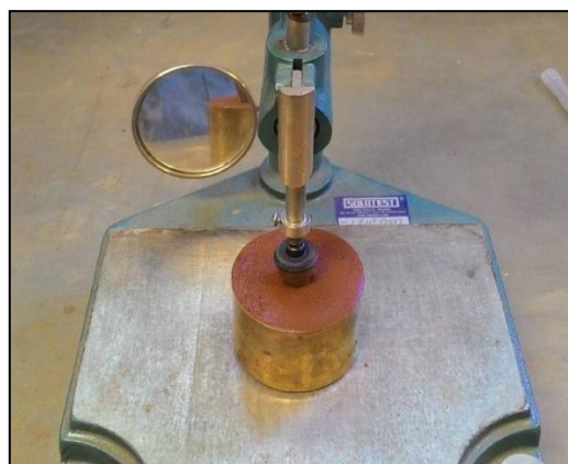
Figura 2. Limite de liquidez determinado pelo cone penetrométrico.
