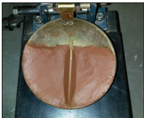
Figura 1. Limite de liquidez determinado pelo aparelho de Casagrande.
