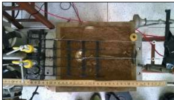
Figura 4. Instalação da geogrelha.
