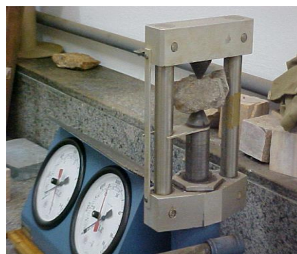
Figura 3. Sistema de aplicação de carga pontual.
