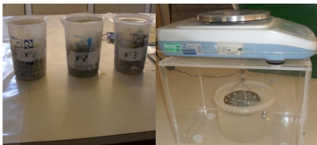
Figura 2. Beckers e balança para a determinação da massa específica, absorção e porosidade.
