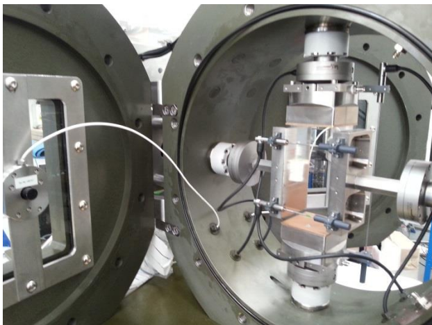
Figura 5. – Visão interna da câmara mostrando os LVDT's.
