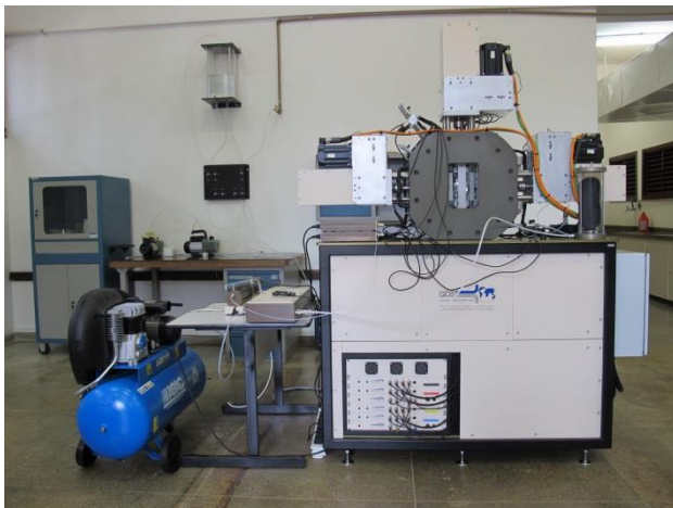
Figura 2. Vista do conjunto destacando-se a câmara triaxial, os atuadores eletromecânicos e os controladores da contrapressão e da pressão de câmara.
