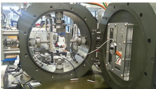
Figura 6. Visão interna da câmara com as duas portas abertas onde se visualizam as células de carga e um dos sensores de proximidade fixado ao visor da câmara à direita.
