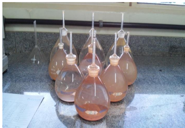
Figura 3: Ensaio de determinação de G_s .
