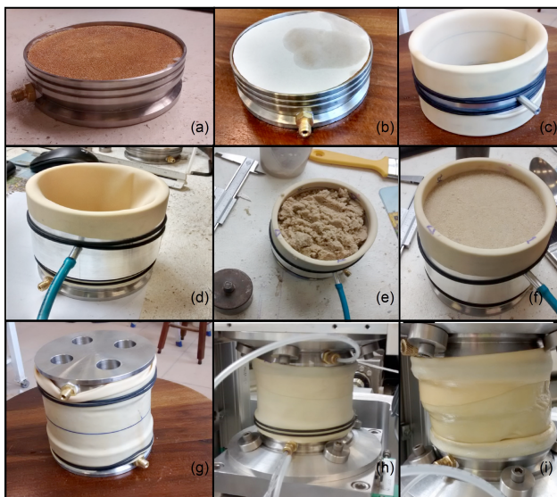
Figura 4. Procedimento de preparação das amostras: (a) colocação da pedra porosa sobre o pedestal; (b) colocação do papel filtro; (c) preparação da membrana no molde tripartido; (d) inserção do molde ao pedestal com aplicação de vácuo; (e) compactação da amostra; (f) finalização da amostra e limpeza da superfície; (g) colocação do top cap ; (h) inserção da amostra no equipamento; (i) amostra após o cisalhamento.
