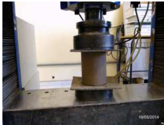
Figura 1 – Rompimentos em prensa hidráulica.
