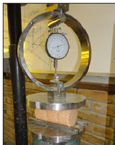
Figura 1. Ensaio de Resistência à Tração por Compressão Diametral.
